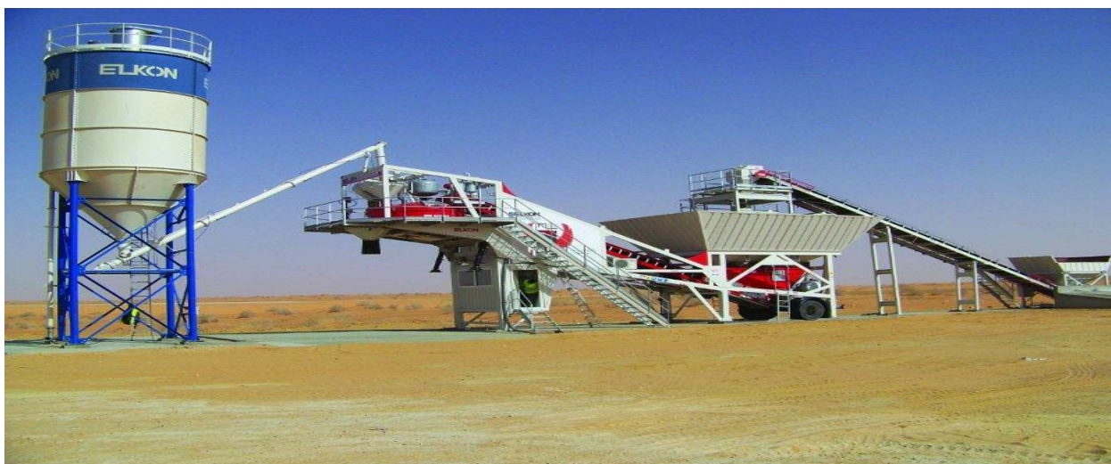
1.17 Сурет – Мобильді бетон завод
